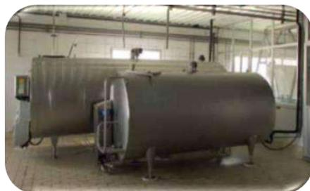
**Figura 16.** Tanque refrigerante artesanal. **Figura 17.** Tanque refrigerante industrial.
